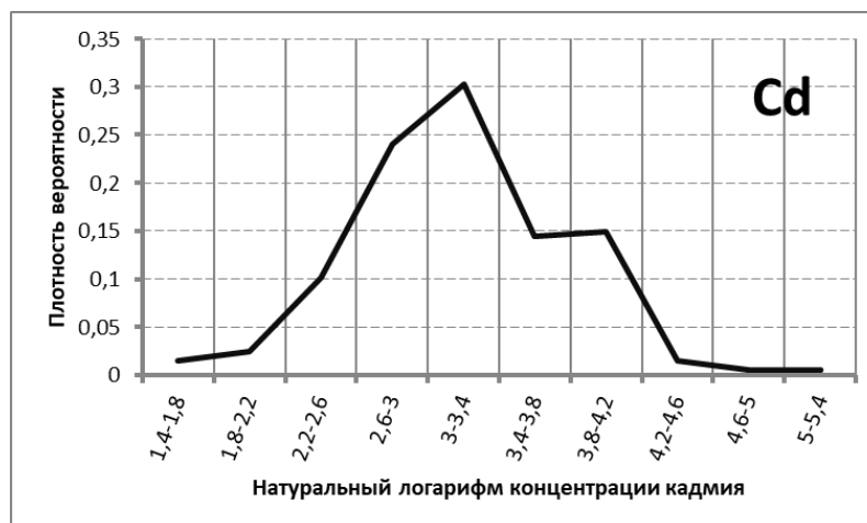
Рис. 7. График плотности распределения вероятности натурального логарифма концентраций кадмия.
