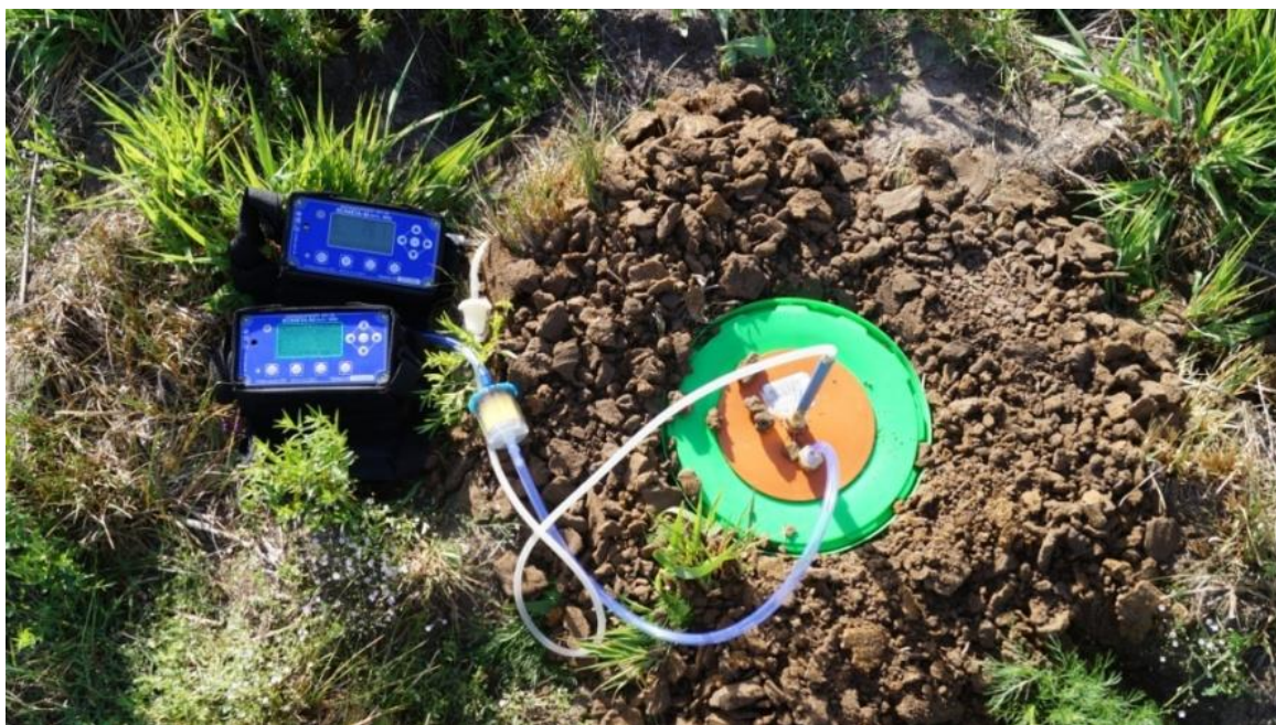
Рис. 2. Измерение содержания газов в подпочвенном воздухе
