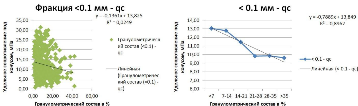
Рис.6. Графики зависимости удельного сопротивления под конусом зонда ( q_c ) от содержания фракции <0,1 мм, частные (слева) и средние значения (справа)
