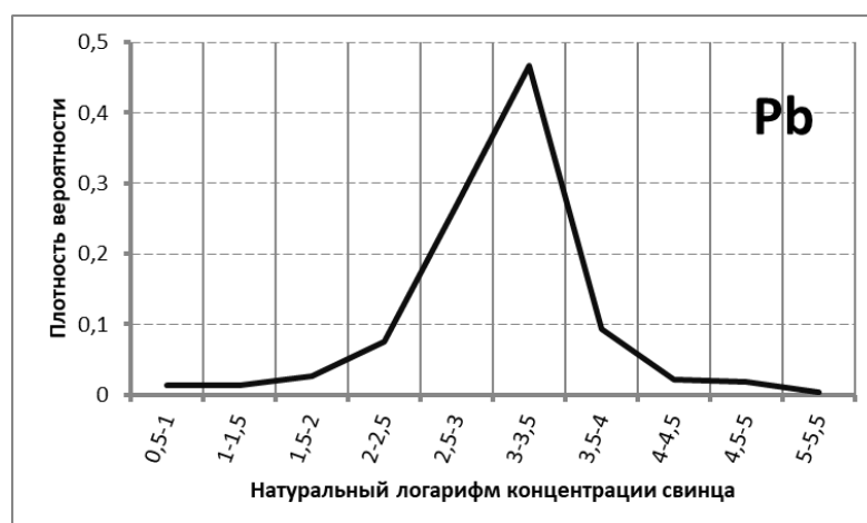
Рис. 8. График плотности распределения вероятности натурального логарифма концентраций свинца.
