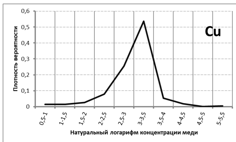
Рис. 9. График плотности распределения вероятности натурального логарифма концентраций меди.
