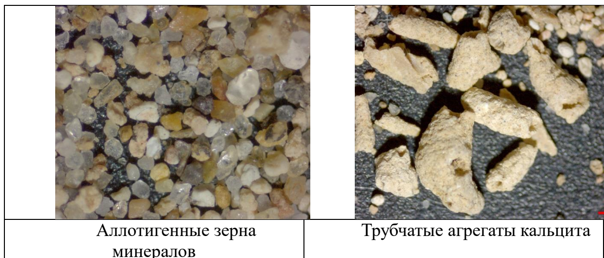
Рис. 1. Фотографии отмытых зерен минералов алевроитовой фракции и трубчатых агрегатов аутигенного кальцита.
